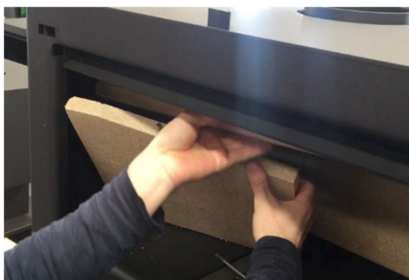
3) 上の板を支えながら上に押し上げ、左の板の上部の突起を抜いて、左の板も持ち上げながら、ストーブの枠に当たらないように慎重に左の板を抜き出します。
