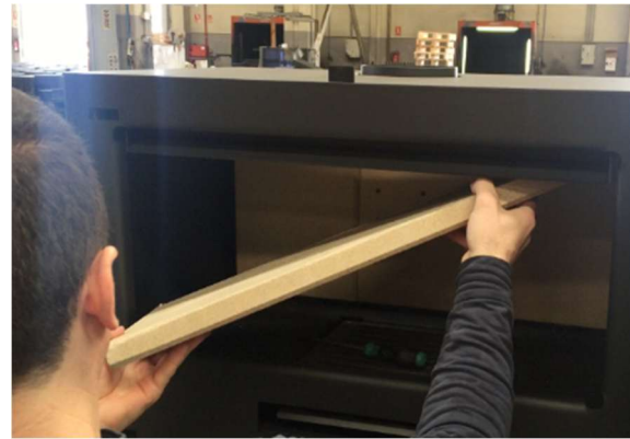
4) 上の板をストーブの枠に当たらないように慎重に向きや傾きを調整しながら取り出します。
