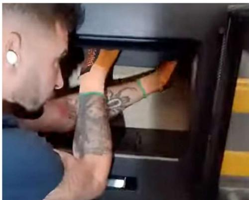
1) 扉を開け、まず天板のパネルを右手で持ち上げながら、左手で左側のパネルを引き上げて取り出します。
