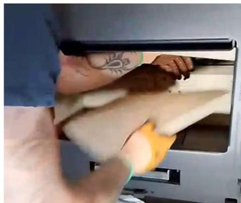
2) 左側パネルを左手に持ったまま、持ち上げた天板パネルを左手の腕で固定した状態で、左側パネルを右手に持ち替え、斜めにしながら取り出します。
