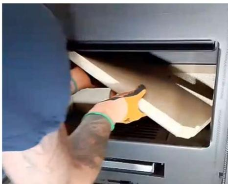
3) 支えていた天板パネルをフレームに当てないように角度を調整しながら(対角線を意識して)ゆっくり取り出します。
