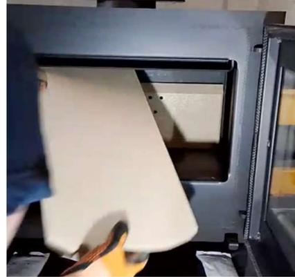
6) 天板パネルを、取り出す時と同様に角度を調整しながら慎重に左側パネルと正面パネルの上に入れ、そのまま左手で持ち支えます。
