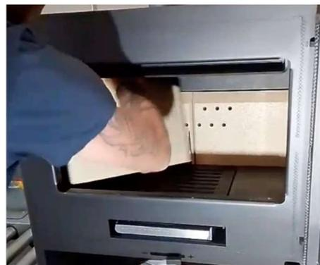
4) 天板を取り出したあと、右側のパネルを持ち上げて引き出します。最後に正面のパネルを取り出します。
