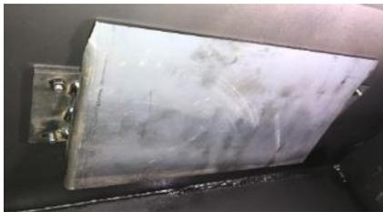
※ 排気口の保護カバー（左図）はナットで固定されています。メンテナンス時は灰や煤を落とし、油を拭き込むなどして錆の防止を行ってください。錆や腐食が進むと、ナットが固着し、ナットが外せなくなる場合があります。
